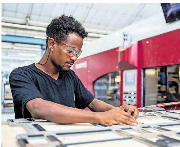
Die Stanzwerkzeuge müssen präzise platziert werden.
